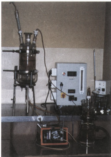
Fot. 1. Układ bioreaktora zasilanego rozpyloną pożywką.
