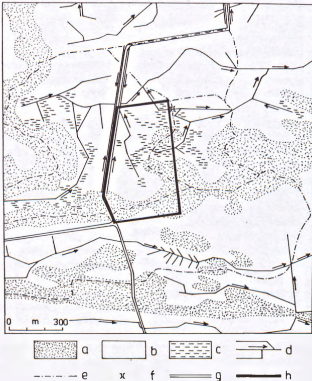
Ryc. 5 Sytuacja hydrograficzna na obszarze rezerwatu „Długosz Królewski” i w otoczeniu. a – suche wyżej wzniesione obszary piaszczyste, b – nisko położone obszary okresowo silnie uwilgotnione, c – najniższe położone obszary na ogół trwale podmokłe, d – rowy odwadniające i kierunki drenazu, e – granice zlewni topograficznych rowów odwadniających teren rezerwatu, w obrębie których proponuje się rozpoczęcie zabiegów zmierzających do renaturalizacji stosunków wodnych, f – niskie działy wodne przecięte przez rowy odwadniające, g – drogi leśne, h – granice rezerwatu przyrody.
