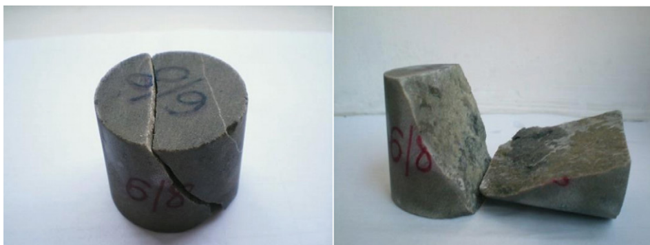
Ryc. 7. Rozpad próby 6/8 – zlepieńca drobnoziarnistego, 805 cykli Disintegration of sample 6/8 – fine-grained conglomerate, 805 cycles
