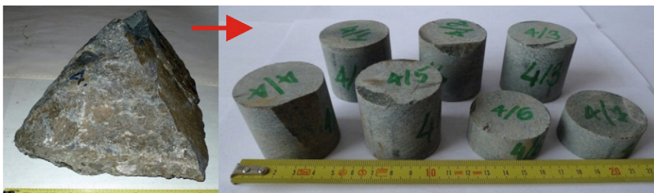
Ryc. 2. Blok i wycięte próby skalne, do symulacji wietrzenia i badań wytrzymałościowych, na przykładzie próby nr 4 Block and cut rock samples, for simulation of weathering and strength tests, as exemplified by sample no. 4
