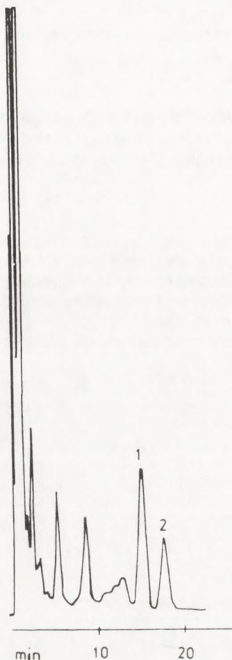
Rys. 3. Chromatogram HPLC frakcji irydoidowej z komórek Penstemon serrulatus hodowanych w podłożu SH-1. Oznaczenia pików: 1 – penstemid, 2 – serulatolozyd. Chromatograf: Shimadzu LC-6A, model 7125. Kolumna: Supelcosil C 8 DB, 5 μm, prekolumna: Supelguard C 8 DB, 5 μm. Eluent: CH 3 OH:H 2 O 32:68 (v/v). Szybkość przepływu: 0,8 ml/min. Detekcja: 220 nm.
