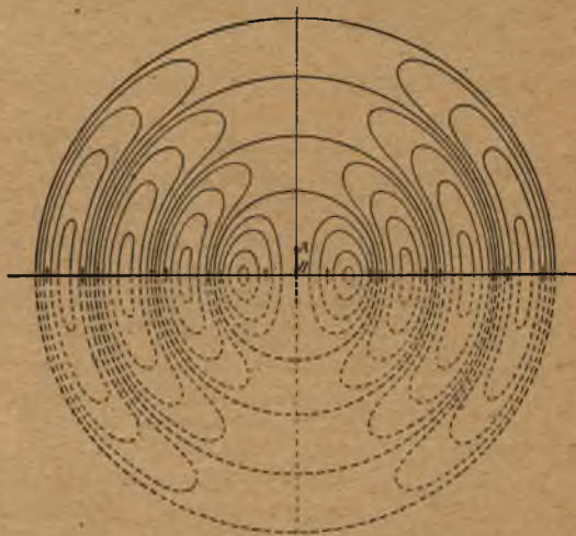
Rys. 2. Gdy wzdłuż AB działa periodycznie zmieniająca się siła elektryczna (do góry i na dół), to w przestrzeni rozchodzi się „fala“ tej siły: ta ostatnia działa wszędzie wzdłuż pętlicowatych linii krzywych (zauważ strzałki!)
