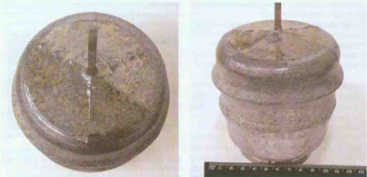
Rys. 9. Kryształ GaP nr 220 o orientacji \langle 111 \rangle po usunięciu z jego powierzchni topnika.
