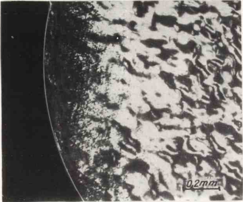
Rys. 7. Dyslokacje na płytce podłożowej po epitaksji a/ na krawędzi płytki, b/ w miejscu wyszczerbienia
