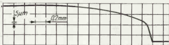
Rys. 1. Profil brzegu płytki krzemowej z zaokrąglonym brzegiem
