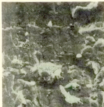
Rys.10. Deformacje plastyczne powierzchni styku ślizgowego, charakterystyczne dla rozwiniętego zjawiska zacierania. W polu widzenia ślady wyciągania i zrywania krystalitów oraz ich przenoszenia i nalepiania. Pow.x500. Próbka 2, obszar 1. 268/28
