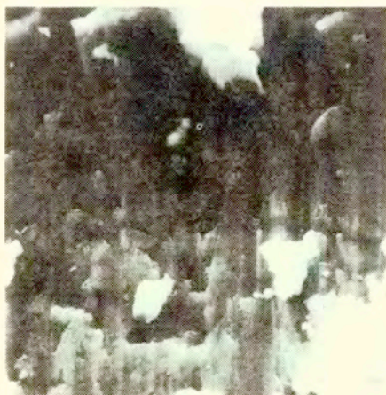
Rys.6. Styk plastyczny ze stopu aluminium. Obraz dna wyrwy powstałej na skutek ścinania ze zdzieraniem warstwy przypowierzchniowej materiału. Ślady urywania ukierunkowanych krystalitów. Pow.x1000. Próbka 2, obszar 3. 268/44
