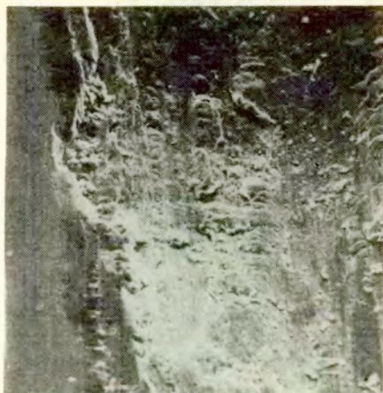
Rys.9. Widok ogólny pasma uszkodzeń styku plastycznego ze stopu aluminium. Pow.x100. Próbka 2, obszar 1. 268/26
