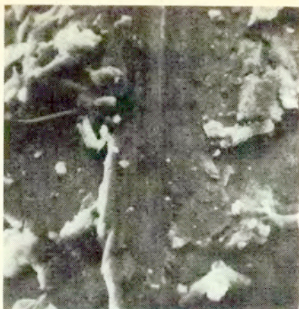
Rys.11. Styk plastyczny ze stopu aluminium. Stadium lawinowego mikroprzenoszenia materiału. Pow.x500. Próbką 3, obszar 1. 268/50
