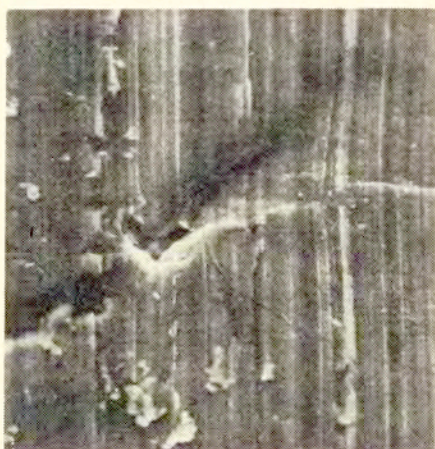
Rys.4. Styk plastyczny ze stopu aluminium. Obraz przedstawiający bruzdowanie powierzchni. Widoczne ślady plastycznego wyciskania na boki oraz mikroprzenoszenia i nalepiania fragmentów oddzielonego materiału. Pow.x500. Próbką 2, obszar 2. 268/36
