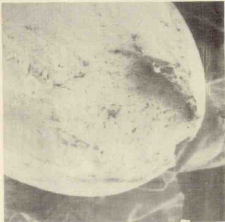
Rys. 15. Drut ITME przetom zerwanej próbki x 46
