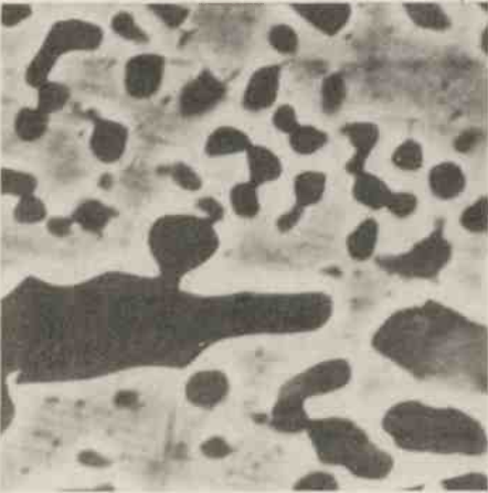
Rys. 9a i b. Obrazy wytrawionego szlifu stopu AuGe12 - A: a - powiększenie 5000x; b - powiększenie 1600x.
