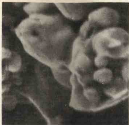
Ryys. 6a i b. Obrazy przełomu stopu WNiCu - B: a - powiększenie 8000x; b - powięk-szenie 3000x.
