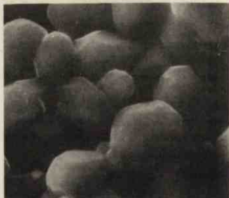
Rys. 3a i b. Obrazy przełomu spiekanej kształtki tlenku glinu, pochodzącego ze szlamu: a - powiększenie 5000x; b - powiększenie 3000x.
