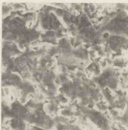
Rys. 2a i b. Obrazy przełomu spiekanej kształtki ceramicznej: a - powiększenie 1800x; b - powiększenie 600x.
