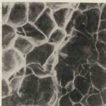
Ryys. 7a i b. Obrazy przełomu stopu CuPb20: a - powiększenie 3000x; b - powięk-szenie 10000x.
