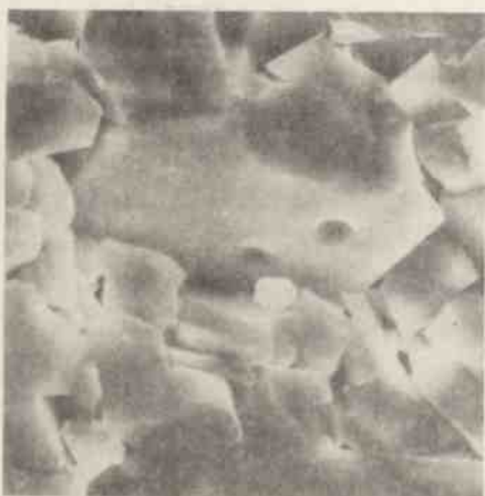
Rys. 2a i b. Obrazy przełomu spiekanej kształtki ceramicznej: a - powiększenie 1800x; b - powiększenie 600x.
