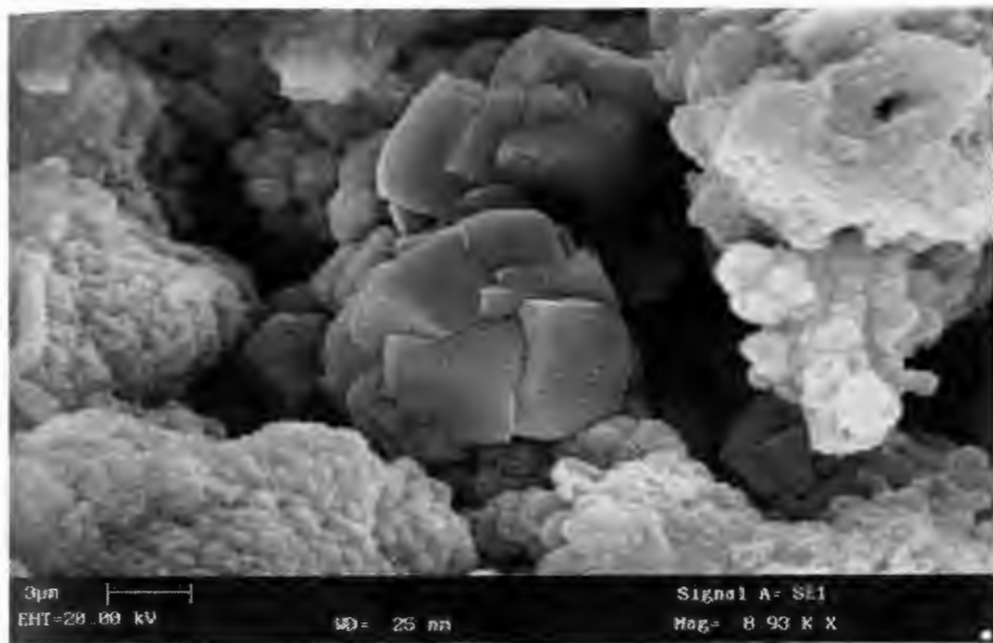
Rysunek 12. Kryształy kalcytu z uwodnionymi tlenkami żelaza i getytu powstały pod działaniem bakterii żelazistych (powiększenie 8930 razy)
