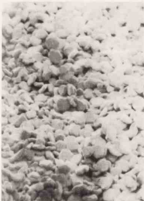
Rys. 9. Przełom próbki spiekanej w temperaturze 1100°C pod ciśnieniem 220 kG/cm 2 w czasie 30 min /pow. 2000x/
