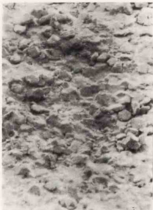
Rys. 12. Powierzchnia próbki spiekanej w temperaturze 1250°C pod ciśnieniem 220 kG/cm 2 w czasie 30 min /pow. 2000x/
