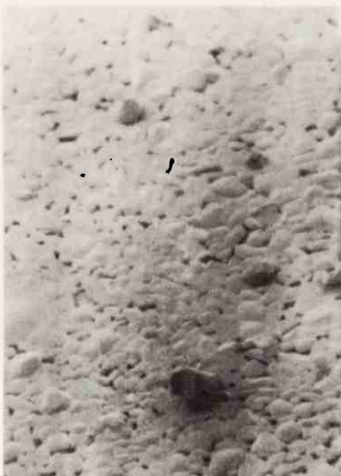
Rys. 11. Powierzchnia próbki spiekanej w temperaturze 1200°C pod ciśnieniem 220 kG/cm 2 w czasie 30 min / pow. 2000x/
