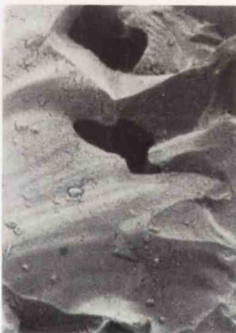
Rys. 16. Przetłom Al 2 O 3 o uziarnieniu 3,5 μm spiekanego bez ciśnienia w temperaturze 1750°C w ciągu 20 min /pow. 2000x/
