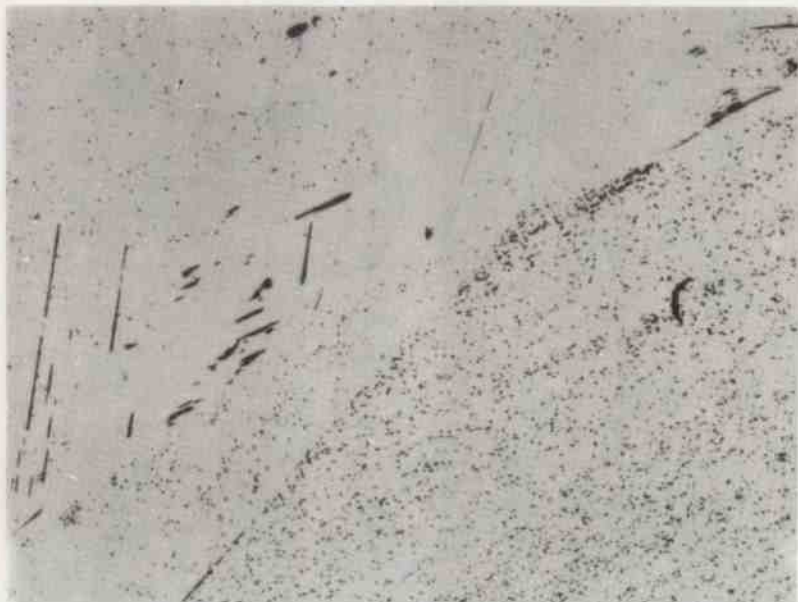
Rys. 9. Struktura taśmy krzemowej - i przekrój wzdłużny /pow. 50x/
