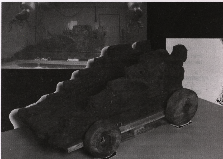
Fot. 3. Przykład obiektu drewnianego poddawanej konserwacji przez radiacyjną konsolidację
