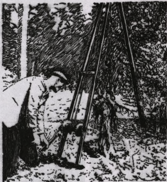
Ryc. 7. Proste urządzenie do wrywania z ziemi karpiny (przerys na podstawie fotografii S. Kasprzyka) (19)
