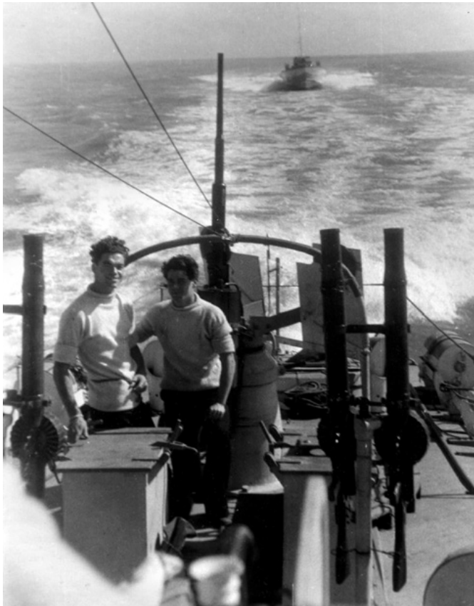
60. Uzbrojenie rufowe ścigacza „S 1” – pojedyncze działko przeciwlotnicze Oerlikon kal. 20 mm oraz dwa zdwojone karabiny maszynowe Lewis kal. 7,7 mm
