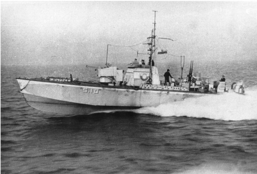
88. ORP „S 10” w marszu z dużą prędkością, 1945 r. Działko plot 20 mm Oerlikona podniesione do pionu. Zwraca uwagę fakt, że wyrzutnia torpedowa jest zdemontowana; pozostała jedynie jej podstawa
