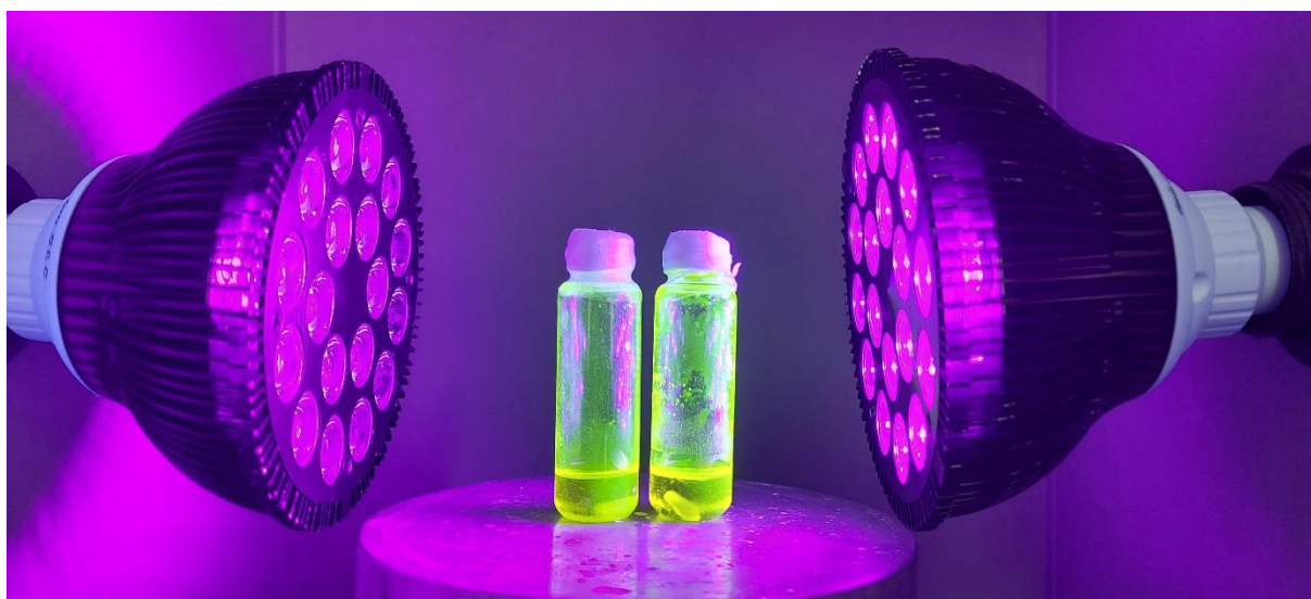
Rys. 2. Zestaw reakcyjny: dwie lampy LED 36W (390-395 nm) i dwa wentylatory (nie pokazane na fotografii).
