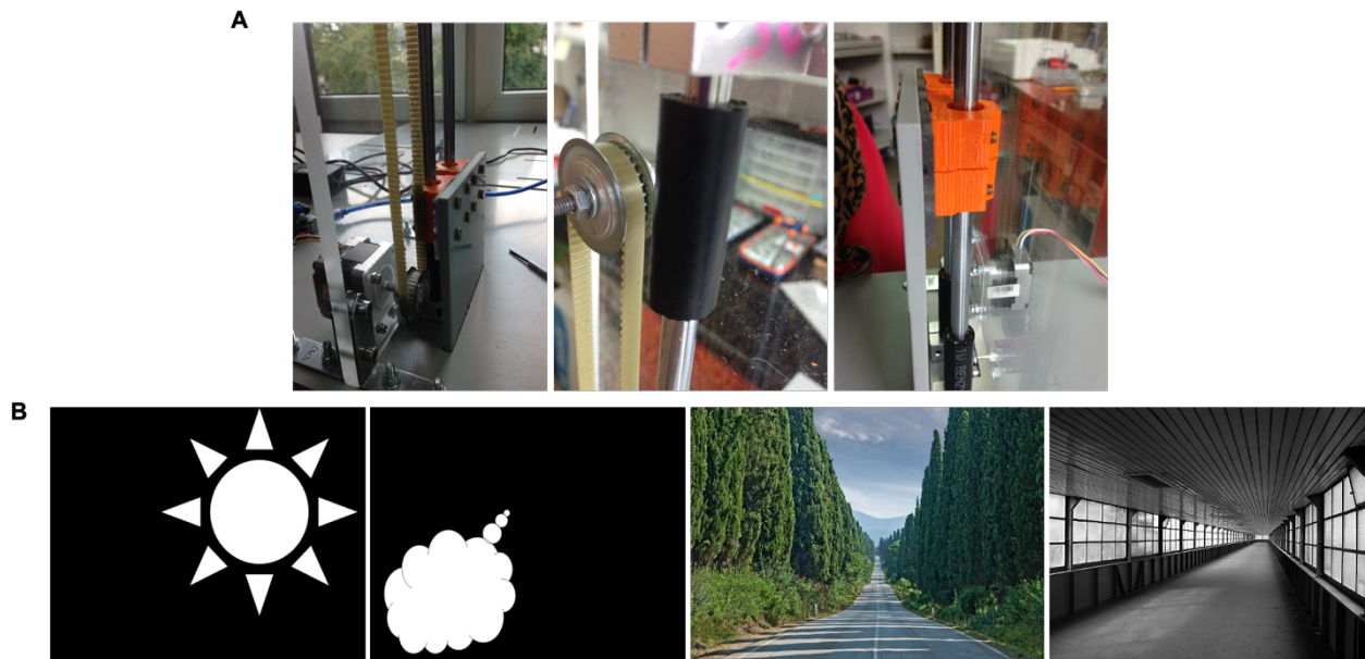
Rycina 10. Fotografie ilustrujące przykład testowanego, prototypowego rozwiązania z zastosowaniem silnika krokowego, koła i pasów zębatych (A). Przykłady testowanych wskazówek przestrzennych przy zastosowaniu konwencjonalnego labiryntu (B).
