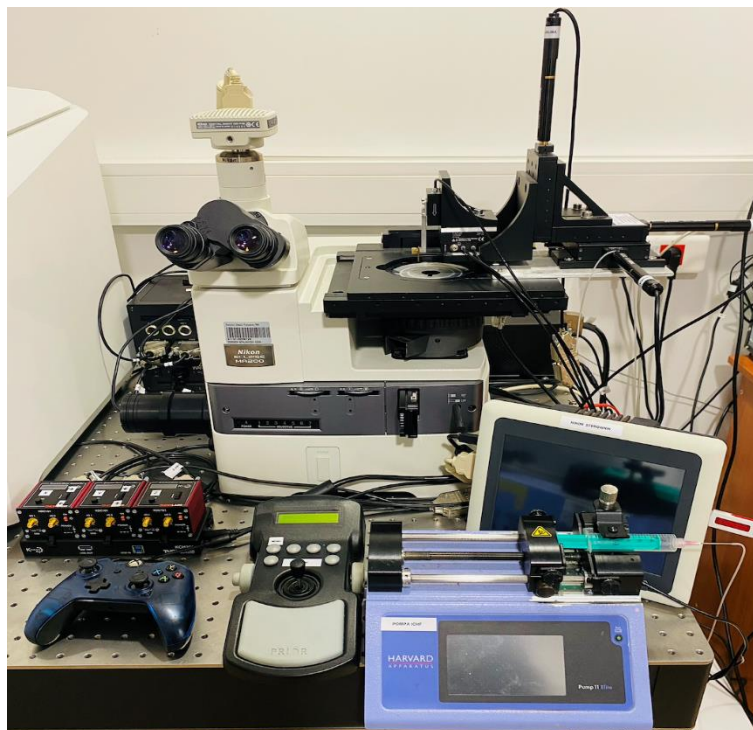
Rysunek 35. Zdjęcie układu optycznego wykorzystywanego do przestrzennej kontroli położenia nanodrutów srebra oraz kropek z kropkami kwantowymi CdTe.
