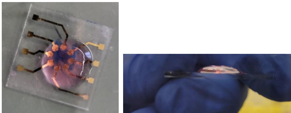
Rysunek 5.21. Hodowla 3D komórek linii HepG2 na rusztowaniu hydrożelowym GelMa po dekonstrukcji całego układu pomiarowego.
