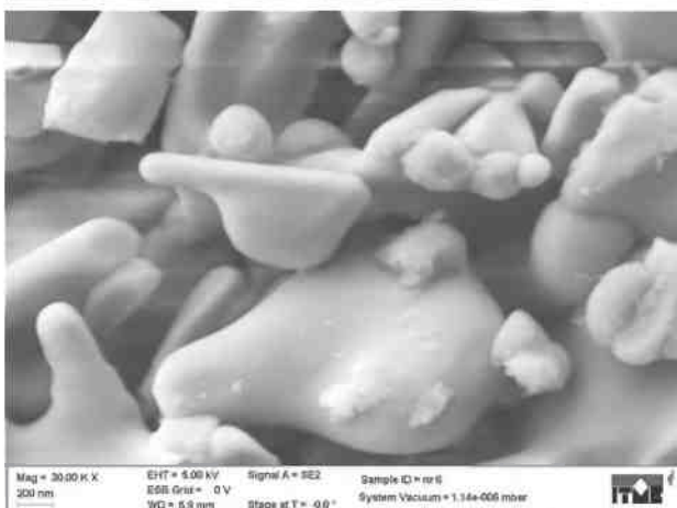
Rys. 3. Zdjęcia SEM \text{Sr}_2\text{CeO}_4 - synteza w fazie stałej (próbka A).
