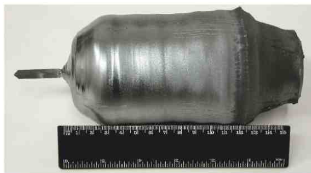
Rys. 8. Widok monokryształu SI GaAs nr 2326 \Phi 3".
