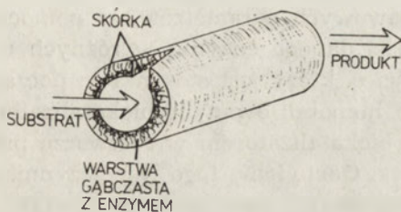
Ryc. 4. Schemat membrany ultrafiltracyjnej w postaci mikrorurki (włókna kapilarnego) z enzymem immobilizowanym w porach membrany
