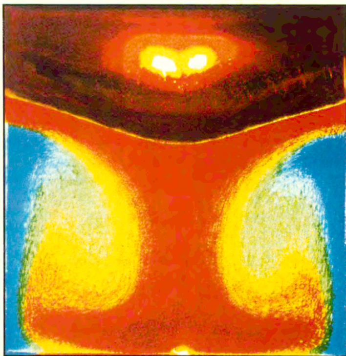
Rys. A 1. Konwekcja naturalna z przemianą fazową w kanale sześciokątnym o ściankach bocznych z pleksiglasu (por. Rys. 7a).
