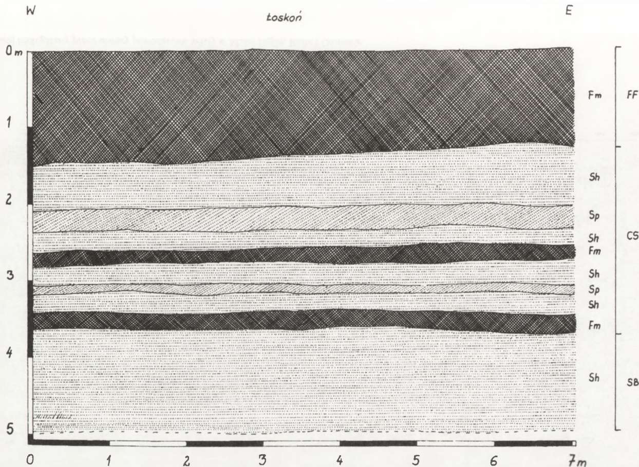
Rys. 5. Odślonienie w obrębie przykorytovej części równiny zalewowej Wisły w Łoskoniu powstałe w czasie budowy wału przeciwpowodziowego w lecie 1996. Oznaczenia kodu litofacjalnego i architekturnego wg A. D. Miall (1996):
