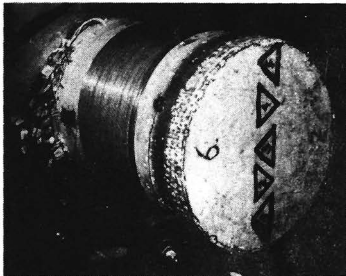
Rys.5. Próbką w trakcie sprężania
