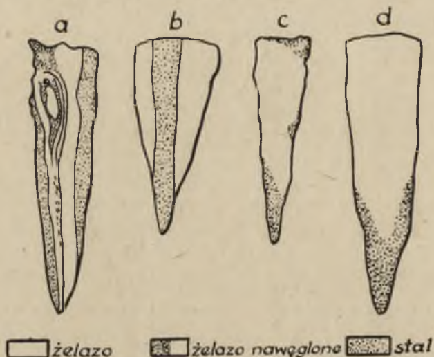
Ryc. 49. Kołobrzeg—Budzistowo. Metody łączenia stali z żelazem w nożach z IX—XII w.
