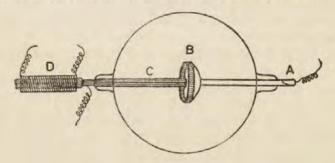
stab A geführt, dessen Ende mit dem positiven Konduktor der Elektrisiermaschine verbunden war, am anderen Ende war ein kupferner Ring B befestigt. C ist ein isolierter
