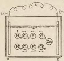
Zinkplatte, von der sie den durch die Pfeile gekennzeichneten Weg genommen haben, durch den Leitungsdraht nach der Kupferplatte.
