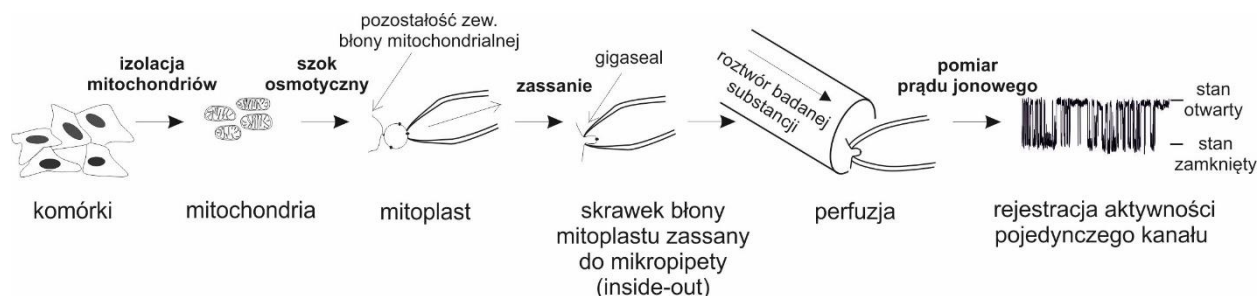
Rycina 12. Schemat techniki patch-clamp przedstawiający poszczególne etapy: izolowanie mitochondriów, przygotowanie mitoplastów, zassanie skrawka błony mitoplastu przez mikropipetę, dodanie badanej substancji oraz przykładowa rejestracja.
