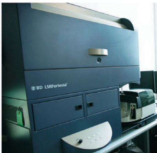
Fig. 3 A-C Część urządzeń stanowiących wyposażenie Pracowni Cytometrii Instytutu Nencykiego. A – cytometr przepływowy BDS FACSCalibur, wyposażony w laser 488 nm i czerwoną diodę 635 nm. B – analizator BD LSR Fortessa wyposażony w lasery 355 nm, 405 nm, 488 nm i 635 nm. C – sorter komórkowy BD FACSria wyposażony w lasery 405 nm i 488 nm oraz lampę UV. Fot. Katarzyna Piwocka.
