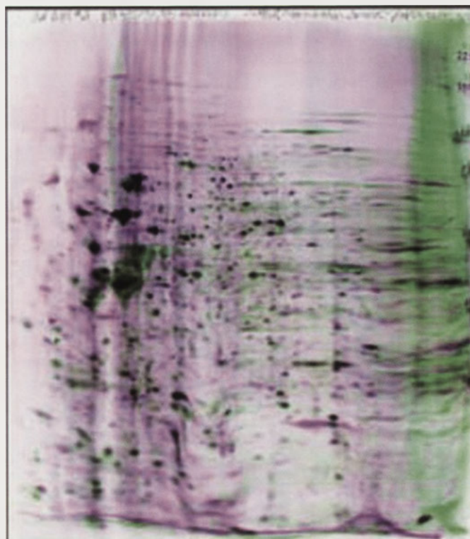
Rycina 3. Porównanie ekstrakcji białek z komórek linii A431 z użyciem detergentu Triton X-100 (kolor purpurowy) i odczynnika TM-PEK B (kolor zielony) [7]. Użyto 200 µg białka całkowitego na próbkę. Kolor czarny wskazuje próbki pokrywające się. Warunki rozdzielania białek z użyciem elektroforezy dwukierunkowej: ogniskowanie izoelektryczne (pierwszy kierunek), pH 3-10 (od lewej do prawej); drugi kierunek 4-15% Tris-HCl SDS-PAGE.
