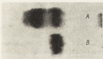
Rys. 1. Zdjęcie elektroforogramu. (A) mieszanina globulin z nasion łubinu wąskolistnego, (B) preparat konglutyny \beta . 0,2 M-bufor weronalowy pH 8,6, 200 V. 0,8 mA/cm. szer. paska, czas 6 godz.; na pasek nakładano ca 10 \mu l 6% roztworu białka
