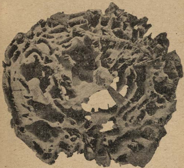
Fig. 24. — Coupe d'une poutre rongée par Calotermes hubbardi (Arizona) (d'après Th. E. SNYDER).
