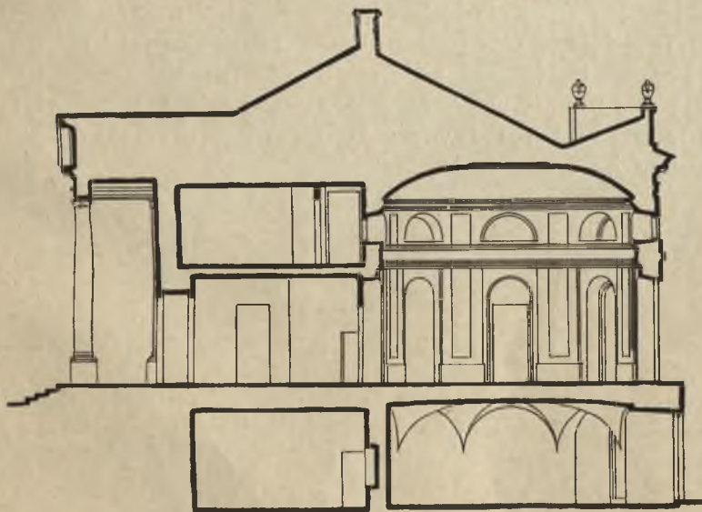
Fig. 21. PAŁAC W IGOŁOMJI. Przekrój poprzeczny. Skala 1 : 250.
