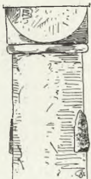
Rys. 67 Widok górnej części trzonu słupa z głowicą, w którym to trzonie wysoki kamienne w kształcie wsporników.
