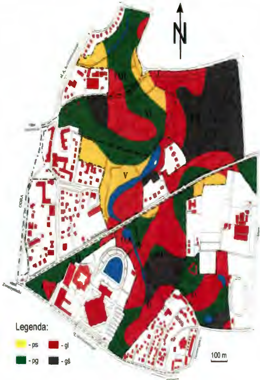
Rysunek 5. Skład granulometryczny w warstwie 5-10 cm: ps – piaski słabogliniaste, pg – piaski gliniaste, gl – gliny lekkie, gś – gliny średnie.
