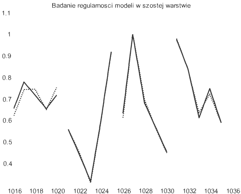
Rys. 23. Badanie rozbieżności w szóstej warstwie w dziedzinie zmiennej wyjściowej znormalizowanej (przebiegi rzeczywiste – krzywe ciągłe, przebiegi symulowane – krzywe przerywane).
