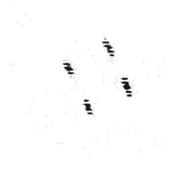
Rysunek 4. Obraz markerów poruszającego się robota dla czasu ekspozycji 1/50 s.
