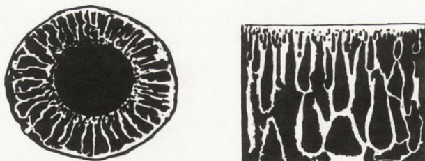
Rys. 1. Struktura płaskiej i kapilarnej polimerowej membrany asymetrycznej.
