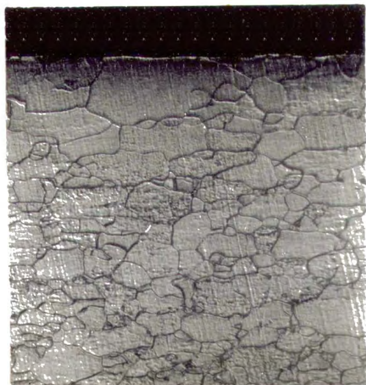
Fot. 6. Mikrostruktura żelaza-armco.
