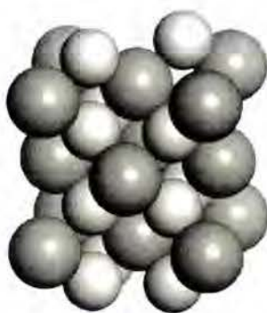
Rys. 32 Rozważana submonowarstwa zbudowana z dwóch atomów wodoru w pozycji mostkowej leżących na diagonalu komórki powierzchniowej (100) \text{TiH}_2 .
