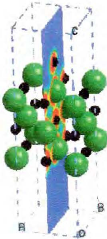
Rys. 50 Przekrój pionowy gęstości elektronowej \rho_0 dla superkomórki z powierzchnią wodoru potasu z zaadsorbowanym atomem wodoru w pozycji wierzchołkowej.
