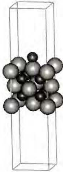
Rys. 44 Rozpatrywana struktura wodoroku tytanu z zaadsorbowanym atomem wodoru w pozycji wierzchołkowej (jasne kule atomy tytanu, ciemniejsze atomy wodoru).
