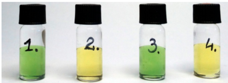
Rys. 6. 9 Zdjęcia wykonane po 30 min. dwufazowej reakcji przeprowadzonej w warunkach beztlenowych (w komorze rękawicowej wypełnionej Ar). Faza organiczna (dolna) w fiolkach 1 i 2 to TFT zawierający: 5 \text{mmol dm}^{-3} DMFc i 5 \text{mmol dm}^{-3} BATB, natomiast w fiolkach 3 i 4 znajduje się 5 \text{mmol dm}^{-3} DMFc w TFT. Faza wodna (górna) w fiolkach 1 i 3 zawiera 0,1 \text{mol dm}^{-3} \text{HClO}_4 + 5 \text{mmol dm}^{-3} LiTB, w fiolkach 2 i 4: 0,1 \text{mol dm}^{-3} \text{NaClO}_4 + 5 \text{mmol dm}^{-3} LiTB.
