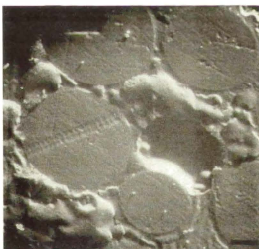
Fot. .2.1÷2.4. 100-krotne powiększenie szlifu ziarna katalizatora E-23 oraz E-30, przed pomiarem oraz po pomiarze, ze śladami wiązki elektronowej
