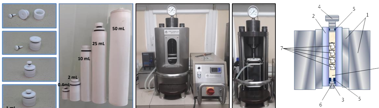
Rysunek 5.1 Teflonowe naczynka reakcyjne, komercyjnie dostępny aparat wysokociśnieniowy U101 wyprodukowany przez Unipress oraz schemat budowy komory wysokociśnieniowej
