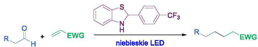
Schemat 3 Zaprojektowana reakcja aldehydów z elektrofilowymi olefinami z wykorzystaniem pochodnej benzotiazoliny jako grupy aktywującej.
