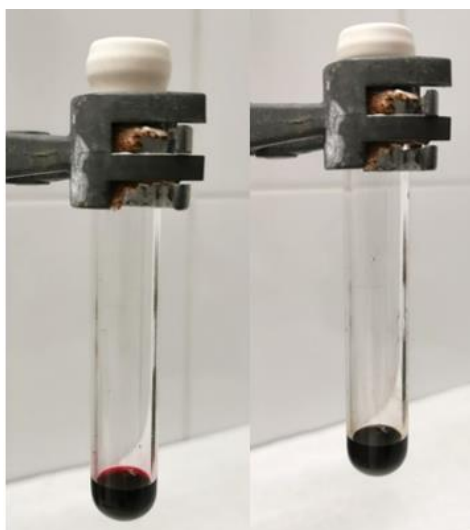
Rysunek 14 Zmiana koloru katalizatora w zależności od stopnia utlenienia jonu kobaltu. Po lewej: forma Co(III) – kolor czerwony; po prawej: forma Co(I) – kolor ciemnozielony.
