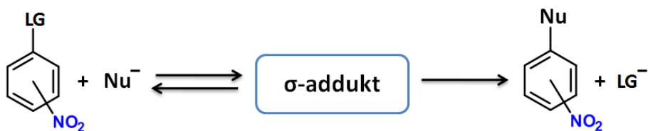
Rysunek 9. Mechanizm typu S_NAr z utworzeniem \sigma -adduktu.
