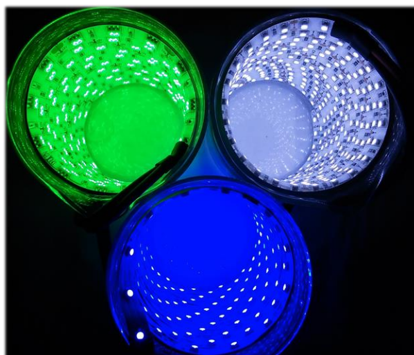
Rysunek 5.2. Zdjęcie fotoreaktorów wykorzystujących taśmę LED.
