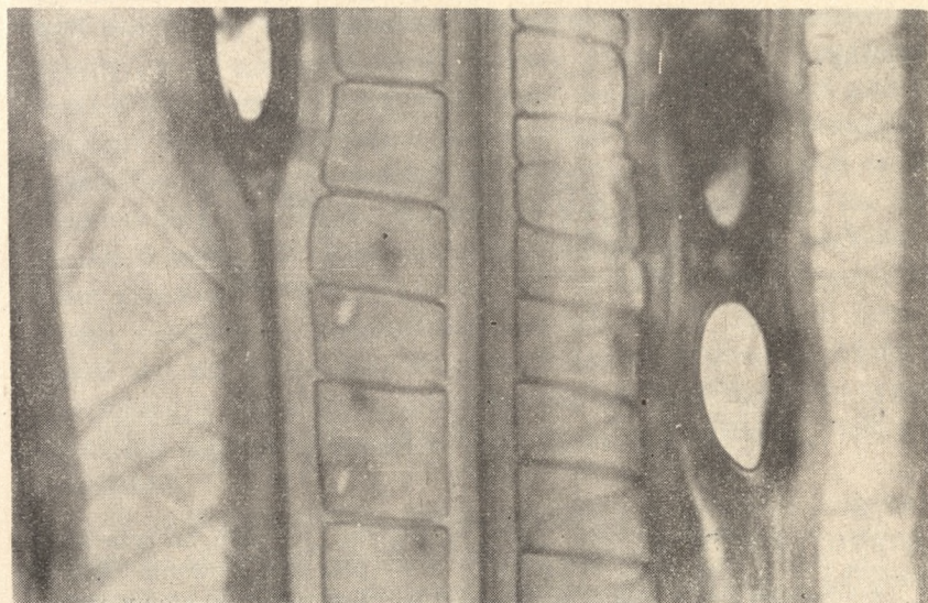
Ryc. 6. Drewno na przekroju stycznym; widoczne spiralne zgrubienia wewnętrznych ścian cewek
