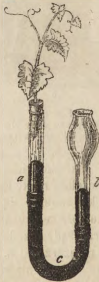
Fig. 19. Manometr do wykazania ssącej siły liści.
