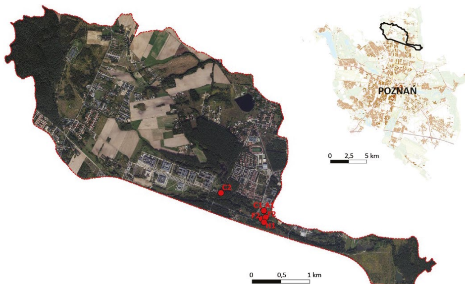
Ryc. 1. Lokalizacja zlewni Różanego Strumienia w Poznaniu i rozmieszczenie stanowisk pomiarowych A1 – posterunek meteorologiczny, C1 – stanowisko pomiarowe składu chemicznego opadu na otwartej przestrzeni, C2 – stanowisko pomiarowe składu chemicznego opadu podkoronowego, F2 – posterunek hydrogeologiczny, H1 – posterunek hydrologiczny Location of the Różany Strumień catchment in Poznań and testing plots placement A1 – meteorological station, C1 – precipitation chemistry site, C2 – throughfall chemistry site, F2 – hydrogeological station, H1 – hydrological station
